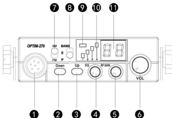
1. Гнездо для подключения микрофона.
